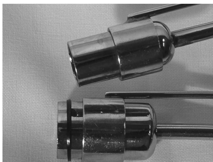
Figure 2 : Mise en place de l'anneau élastique sur le cylindre interne
