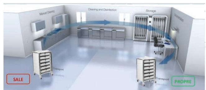
**Figure 1 : Circuit recommandé pour la réorganisation de la salle d'endoscopie**
